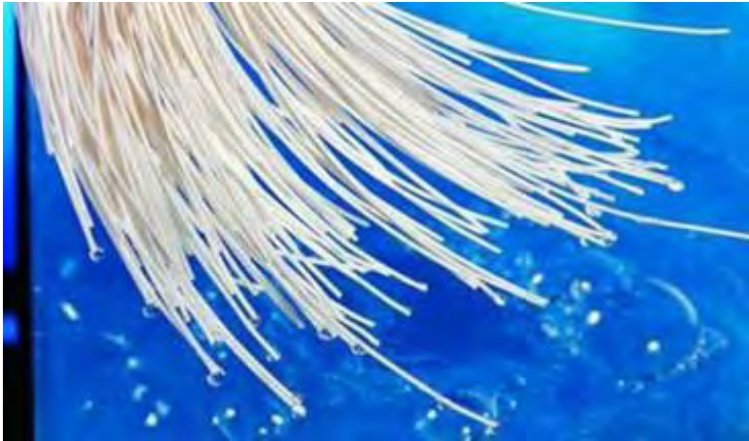
Imagen 5, Fotografía de fibras huecas PVDF
